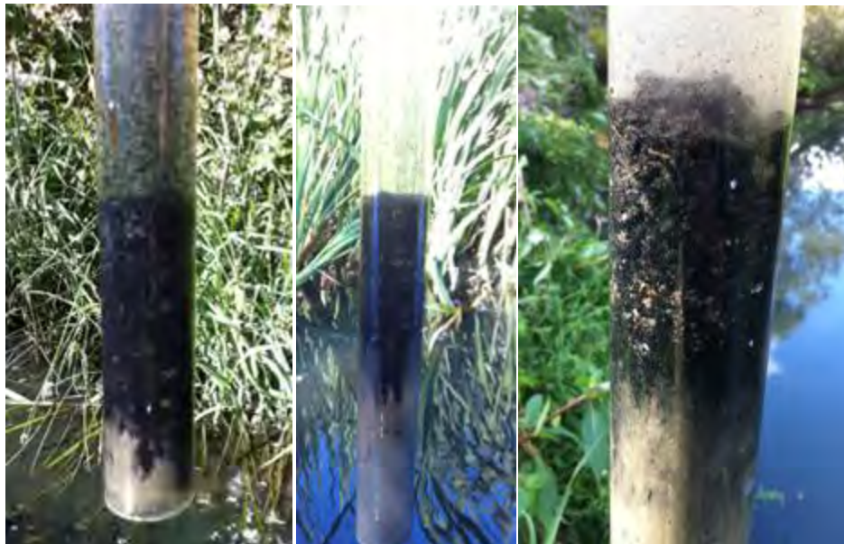
Figur 8 Kärnprover från bottensediment. Till höger: Prov taget i övre delen av det föreslagna saneringsområdet. Tjockleken av det organiska materialet är ca 10 till 15 cm. Mitten: Prov taget i mittersta delen av sträckan. Tjockleken 30 till 40 cm. Till höger: Prov taget i nedersta delen av området. Tjockleken ca 10 cm. Det bör noteras att provet bara är taget 1 m ut från åkanten på grund av att det var för djupt för att med vadarstövlar ta ett prov i mitten av fåran.
